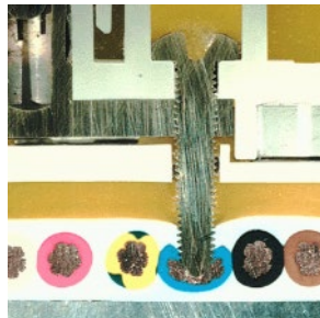
Abb. 2: Schliffbild einer Kontaktierungsstelle
